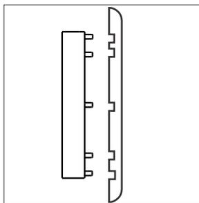
3. Encaixe o adaptador que irá utilizar na grade, observando que cada torre se encaixe em um orifício.
