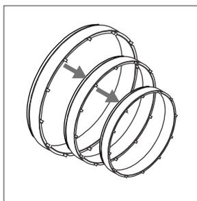
2. Destaque / separe cuidadosamente os adaptadores e verifique qual deles irá utilizar, dependendo do Ø de encaixe / tubo.
